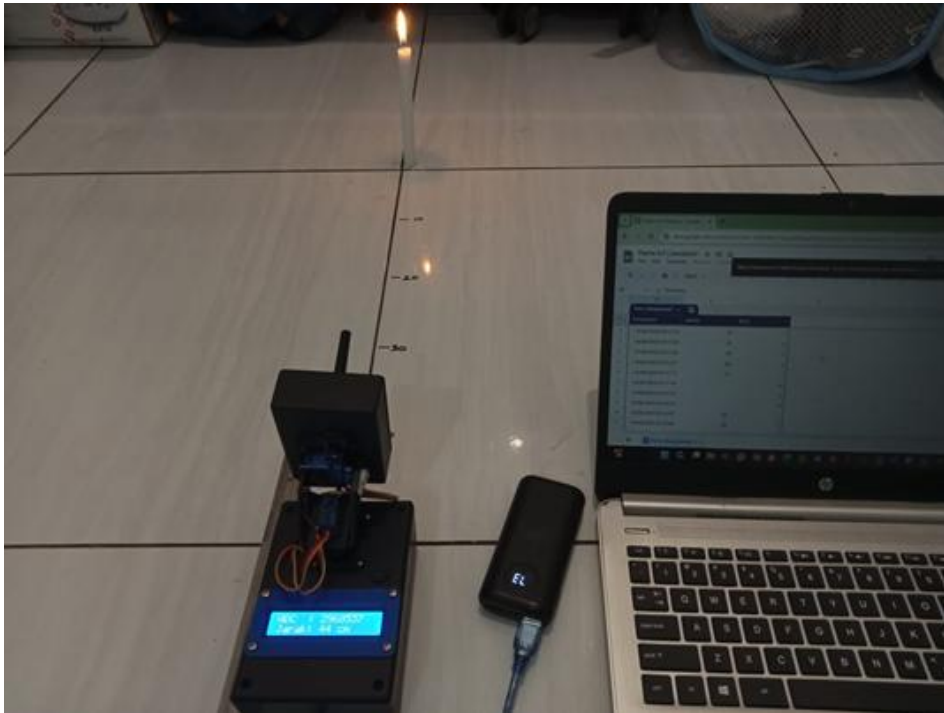
Gambar 6. Instalasi untuk uji fungsi prototipe dalam mendeteksi dan mengukur jarak api terhadap sensor dengan standar ukuran panjang berupa mistar baja
