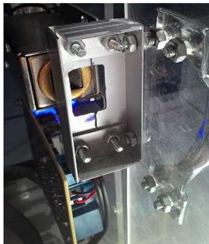
Gambar 4. Solenoid (on) membuka pengunci pintu
