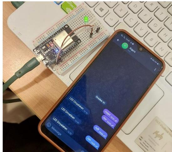
Gambar 5 Pengujian fungsionalitas LED
