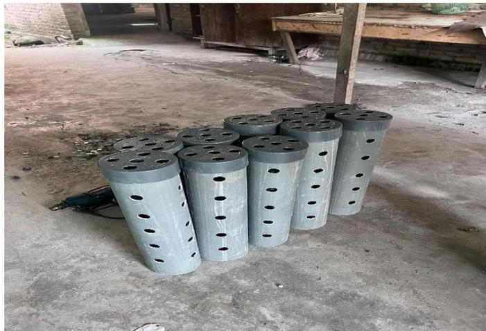
**Gambar 2.** Hasil Pemetongan dan Pelubangan Pipa Biopori
