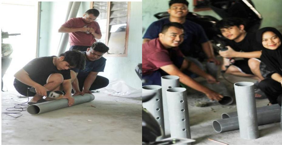
**Gambar 1.** Proses Pembuatan Pipa Biopori
