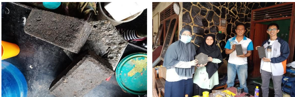
Gambar 8. Paving Block sebagai Produk Padat Residu Plastik yang dihasilkan oleh Mitra
