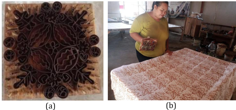
(a) (b) Gambar 9. Alat Teknik (a) Model Cap Batik Berbahan Kertas ( Paper stamp ) (b) Proses Membatik Menggunakan Cap
