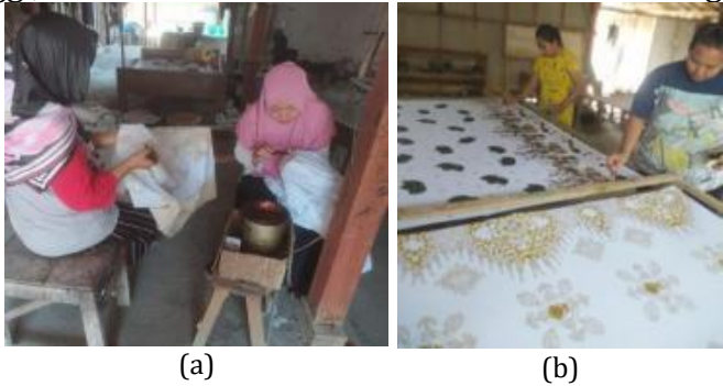
Gambar 2. Proses Manual (a) proses penyantingan dan (b) proses pewarnaan kain batik
