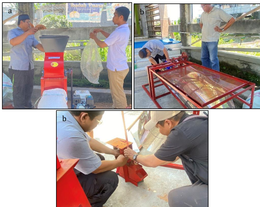
Gambar 2. Proses pengolahan sabut kelapa menggunakan mesin penghancur, mesin ayak, dan mesin press
