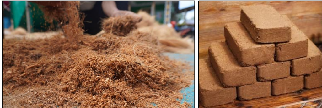
Gambar 3. (a) Bentuk awal cocopeat setelah tahap penghancuran; (b) cocopeat setelah proses pencetakan
